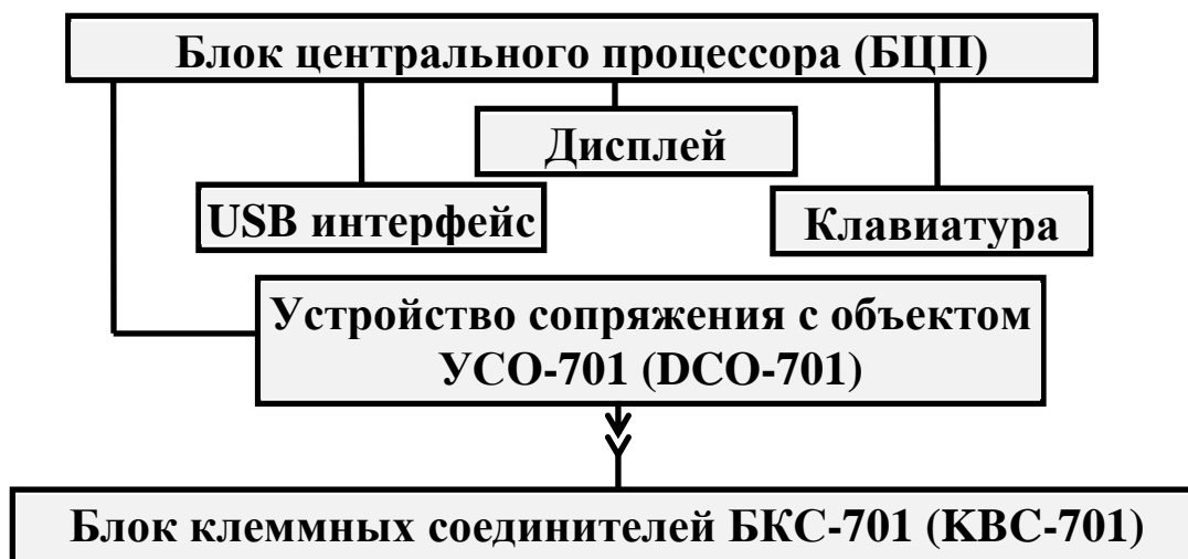
Рисунок 2 - Структурная схема контроллера
