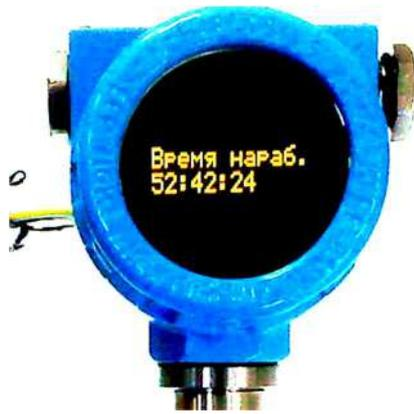
Рисунок 2 – Преобразователь ЭП с цифровым индикатором
