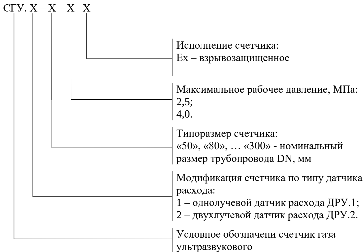
Рисунок А.1 – Структура условного обозначения счетчика газа
