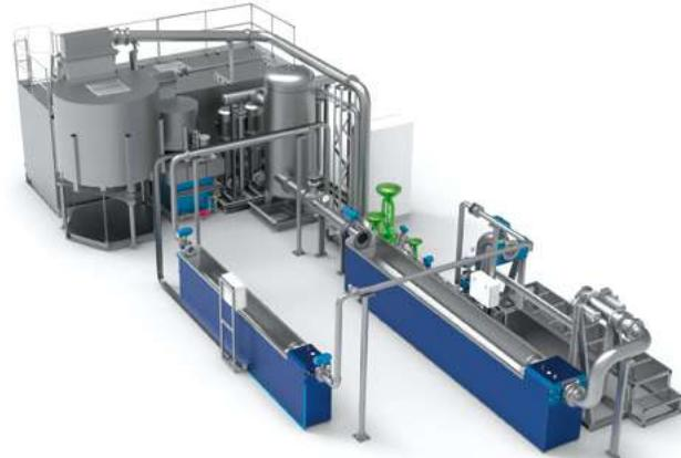
УСТАНОВКА РАСХОДОМЕРНАЯ ПОВЕРОЧНАЯ СЕРИИ РУ. МНЕМОСХЕМА
