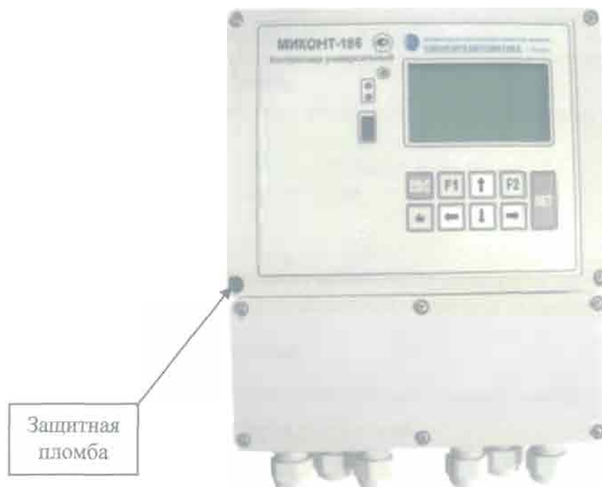
Рисунок 1– Схема пломбировки контроллера МИКОНТ-186 от несанкционированного доступа.
