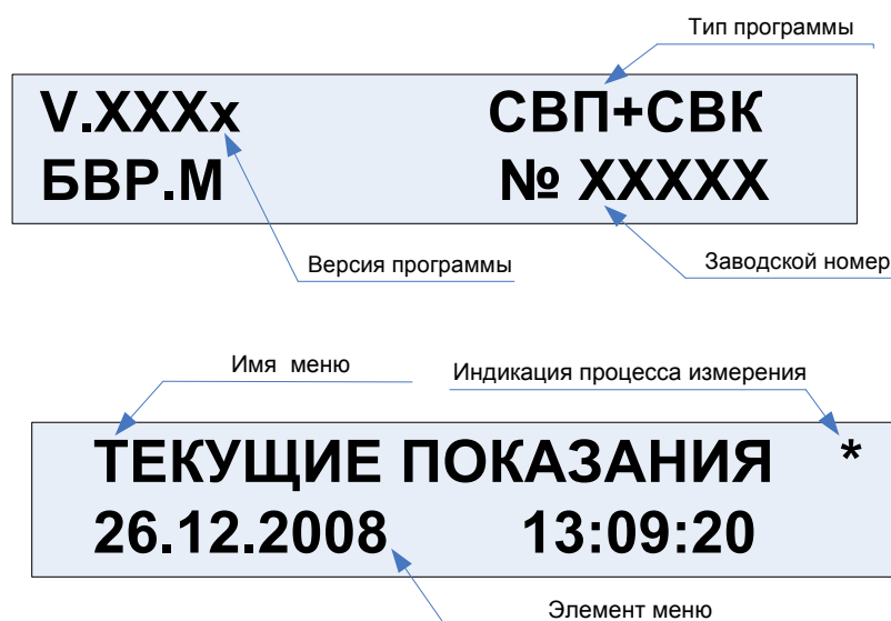
Рисунок 3 - Смена информации на дисплее блока БВР.М после включения
