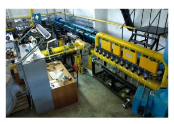
УСТАНОВКА ПОВЕРОЧНАЯ ГАЗОВАЯ УПГ. МНЕМОСХЕМА
